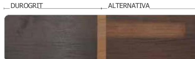
El resultado de la muestra de madera tras la prueba de fricción. Como puedes ver, sobre el producto alternativo se nota claramente el recorrido del cepillo, mientras que en el DuroGrit apenas se aprecia.
