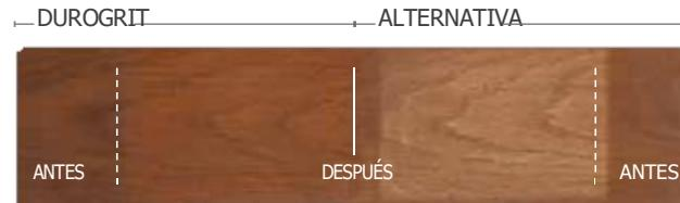
Prueba de protección UV al cabo de un tiempo con el color FoxyBrown sobre teca y un producto alternativo con sistema de 2 capas.
